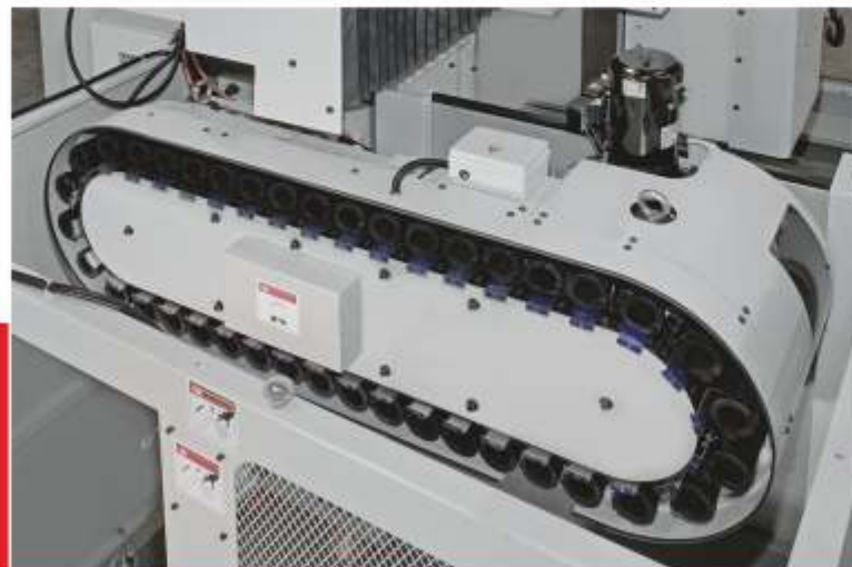
Magazzino utensili - Arm type tools ATC
